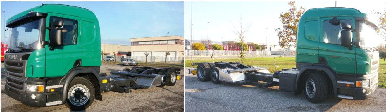
La trasformazione a 3 assi raffigurata in foto, si ottiene partendo da uno Scania LB 4X2 MLB, e viene realizzata mediante **l'abbassamento del telaio**, nella zona centrale, ed **applicando un assale intermedio fisso**, con ruota singola da 17.5", con massa limite 4360 kg, con sospensione pneumatica e con dispositivo di sollevamento automatico.
