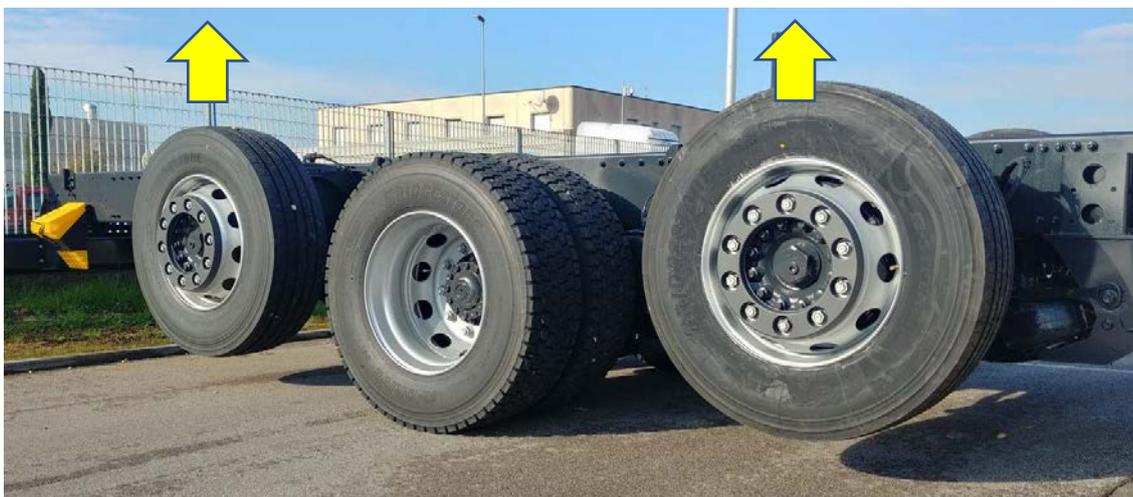
Nel momento in cui l'asse motore (3° asse) raggiunge circa l'80% della sua portata massima di 12000 kg (ovvero circa 9500 kg) l'assale posteriore (4° asse) si abbassa automaticamente e quindi ridistribuisce il carico sul tandem (3° e 4° asse).
