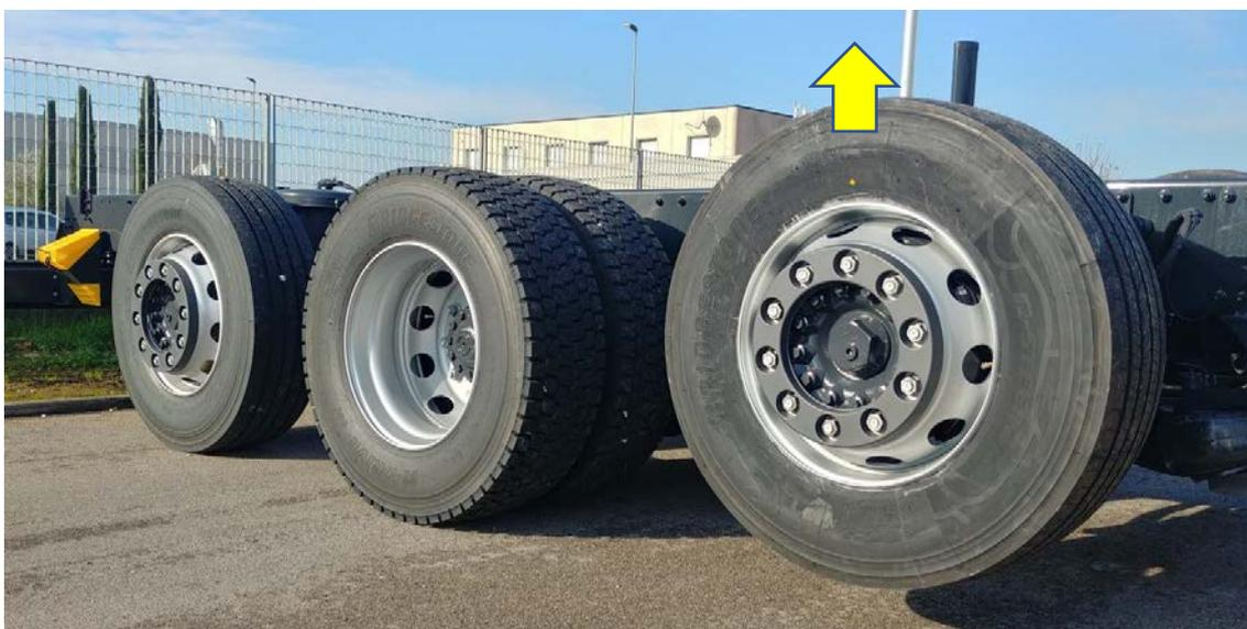
Nel momento in cui anche l'asse in coda raggiunge circa l'80% della sua portata massima di 8000 kg (ovvero circa 6500 kg) l'assale centrale (2° asse) si abbassa automaticamente e quindi si ridistribuisce il carico sul tridem (2°, 3° e 4° asse).
