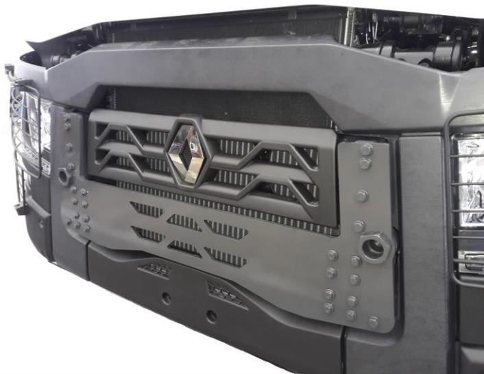
L'applicazione della struttura frontale può essere effettuata direttamente dal carrozziere che applica la gru in quanto viene fornito un kit che andrà bullonato (secondo direttive Volvo) sugli ancoraggi già presenti nella parte anteriore del veicolo.
